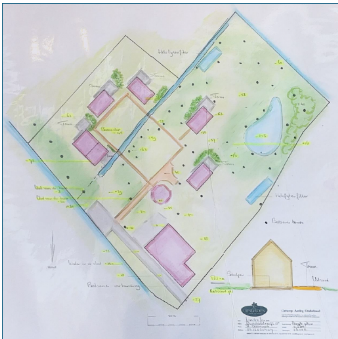
Figuur 4: Ingemeten hoogtes, inclusief sfeerbeeld woningen en terrassen plangebied Uit deze figuur blijkt dat het hoogteverschil tussen het huisperceel en N37 beperkt is. De drie woningen op N37 komen slechts 30 cm boven het huidige peil te liggen. Nieuw te bouwen woningen komen op schroefgaten om te voorkomen dat er aantasting van de bodemstructuur kan plaatsvinden. Onder de woningen komt een schelpenpakket in verband met optrekkend vocht. Bij de huizen komen geen individuele tuinen, maar terrassen die aansluiten op de woningen, ofwel het wonen vindt enigszins 'op hoogte' plaats.
